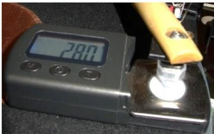
Lösen Sie zunächst leicht die beiden M4 Inbusschrauben. Anschließend lässt sich das Gegengewicht hin und her schieben. Versuchen Sie, sie erneut zu fixieren, wenn die empfohlene Auflagekraft ungefähr auf Ihrer Tonarmskala zu sehen ist.
