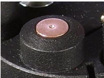
Das Lager ist ein Einpunktlager. Es wird durch magnetische Anziehung und eine Wirbelstromdämpfung der Lagerschale aus Kupfer verstärkt.
