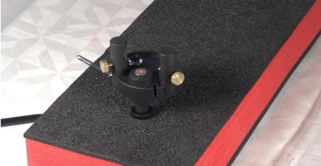
Legen Sie den Schaumstoffblock auf eine ebene und waagerechte Fläche vor sich hin. Wählen Sie ein 6-mm-Loch zur vorläufigen Fixierung der Lagereinheit des SAMBUCO. Der Schaumstoffblock simuliert die Tonarmbasis Ihres Plattenspielers.
