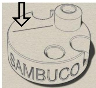
Es gibt noch eine zweite Einstellung, die über denselben Montagezapfen vorgenommen wird: Sie können die SAMBUCO-Tonarmbasis horizontal drehen. Oben auf der (runden) Tonarmbasis sehen Sie eine kleine Nut. Sie sollte zur Plattenmitte zeigen. Dadurch wird sichergestellt, dass die beiden Anti-Skating-Magnete in einer guten Position sind, um ihre Arbeit zu verrichten. Ziehen Sie dann die M6 Stahl-Kontermutter unter der Tonarmplatte fest, um den Tonarm in seiner Position zu fixieren.
